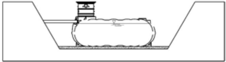
8. Setzen Sie die Erstellung einer Umhüllung des Tanks mit Verfüllmaterial (Rundkornkies 8/16mm) bis mind. 200mm über Tankschulter fort.
