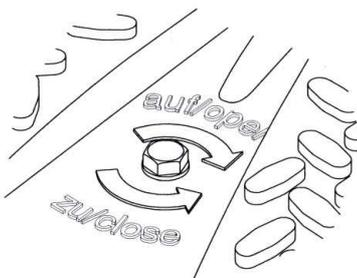
Durch Drehen am Sechskantkopf der Schraube an der Oberseite des Deckels wird der Riegel (B) betätigt und der Sicherungsriegel geöffnet oder geschlossen. Hierbei greift der Riegel in eine Tasche oder unter die Innenkante eines Revisionschachts fasst (Punkt 2.2.1) Es ist maximal nur eine Vierteldrehung nötig. Die Drehrichtung ist auf der Oberseite des Deckels angegeben.
