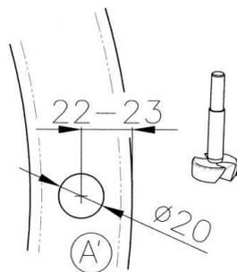
Bei Revisionschächten direkt am Tank ist die Bohrung für den Arretierstift werksseitig angebracht und die Ausrichtung des Deckels damit festgelegt. Wenn die Ausrichtung geändert werden soll, kann eine zusätzliche Bohrung **A** angebracht werden, siehe Abbildung links.
