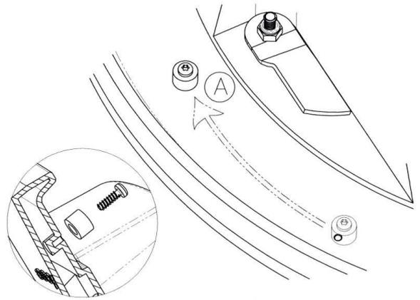
Die Abbildung rechts zeigt die Deckelsicherung an einem Revisionschacht in geschlossenem Zustand
