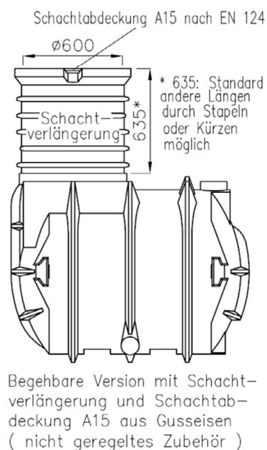
Abflusslose Sammelgruben aus rotationsgeformten Polyethylen (PE-LLD)
