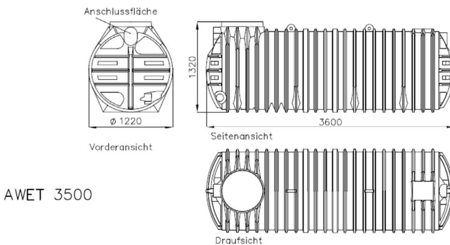
Abflusslose Sammelgruben aus rotationsgeformten Polyethylen (PE-LLD)
