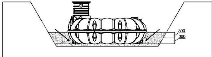
5. Verfüllen Sie im Anschluss die Durchzüge des Tanks mit Verfüllmaterial (Rundkornkies 8/16mm) besonders sorgfältig. Stellen Sie durch manuelles Nachstochern sicher, dass auch schwer zugängliche Hohlräume gefüllt und verdichtet werden.
