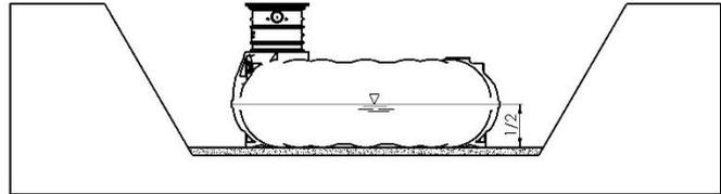
4. Verfüllen Sie den Raum zwischen Außenseite des Behälters und Baugrubenwand in Lagen von 300mm mit Verfüllmaterial (Rundkornkies 8/16mm) und verdichten Sie jede Lage bis zum Tankäquator sorgfältig manuell (z.B. mit Handstampfer).
